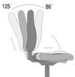
4/3. ábra dinamikus ülést biztosító szék
